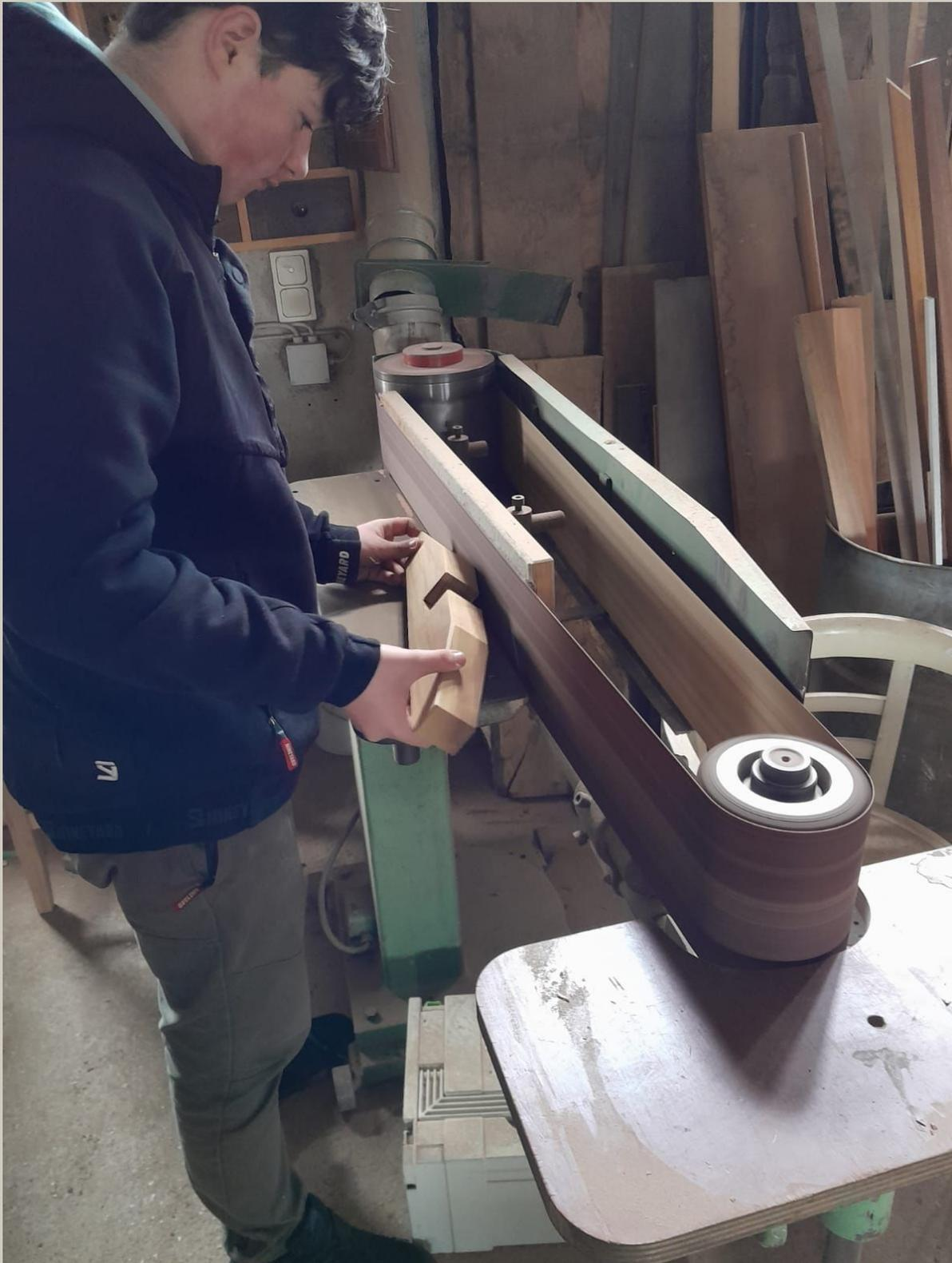
Die Fasen haben wir mit einer Bandschleifmaschine angeschliffen.
